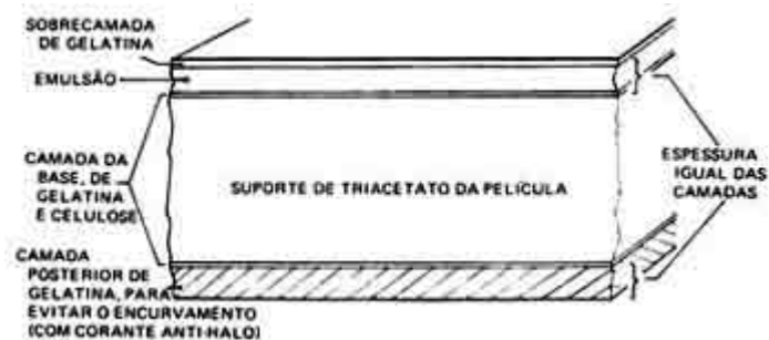
Fig. 1 – Estrutura da película preto-e-branca
